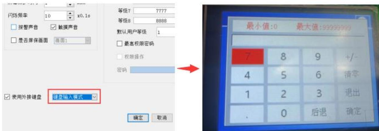
⑤若勾选使用外界键盘，同时选择按键修改模式时，是通过上下键和右移键修改数值大小，而不是弹出数值键盘修改，如下图所示，如果数值控件有输入功能就会有白色边框，选中的数值控件则显示红色边框，选中数值控件后第一次点 SET 键是确认进入选中数值控件的数值修改，确认后数值控件中数值最右边的位开始闪烁，通过右移循环 RIGHT 键选择数值控件上数值的其他位，被选中的位会闪烁，然后通过 UP 键按一次加 1，DOWN 键按一次减 1。再次点 SET 键就是确认修改数值完成，如果修改中欲退出不修改，点 ESC 键就退出数值修改,按键操作时,会将的按键对应的位地址置位（参考表 1-1）。
