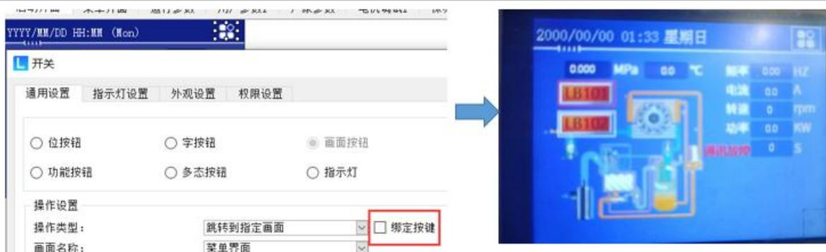
②若可操作控件的[绑定按键]被勾选时，可以用于操作控件的触发；如画面按钮绑定 ESC，在点击 ESC 键时，就会操控该画面按钮跳转至指定的画面（菜单画面），且 LB103 也会被置位。同理，如果绑定 1，可以用 START 键来操控该画面按钮，且会将 LB101 置位，如果绑定 2，可用 STOP 键操作该画面按钮，且会将 LB102 置位，所以客户可以在操作控件时用对应的位地址用于宏逻辑控制。
