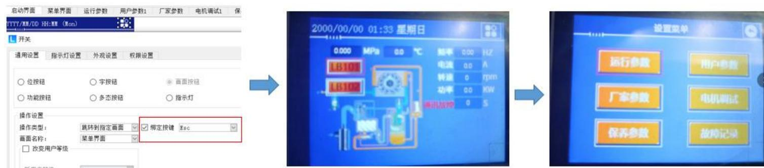
③在画面中,可操作的控件有白色边框,被选中的操作控件则显示红色边框,若要切换欲操作的控件,通过 UP、DOWN 以及 RIGHT 键选择需要操控的控件,选中后点 SET 键即可操作该控件。操作 UP、DOWN 以及 RIGHT 键以及 SET 键对应的位也会被置位（按键对应地址参考表 1-1）。
