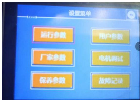
④若勾选使用外接键盘，同时选择键盘输入模式时,通过 UP、DOWN 以及 RIGHT 键选择欲修改的数值控件，选中数值控件后点 SET 确认会弹出数值键盘，在输入数值时，通过 UP、DOWN 以及 RIGHT 键选择数字，选择中的数字会显示红色底色,SET 键点击确认所选择的数值键盘上的数值，按键点 ESC 按键可以退出键盘,按键操作时,会将的按键对应的位地址置位（参考表 1-1）。
